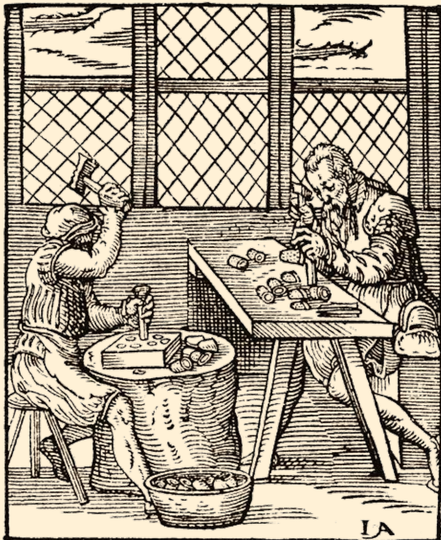
Pilt 2. Sõrmkübarate valmistamine survevalu meetodil ning nende katmine lohkudega. Joonis: Amman & Sachs 2005. [1568]. Der Fingerhuter. - Eygentliche Beschreibung aller Stände /—/. Leipzig: Edition Leipzig.
